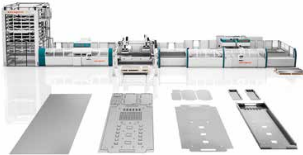
Abbildung 5: Salvagnini LEAN PANEL BENDER: Von der Platine automatisch, ohne Unterbrechung, zum fertigen Produkt
